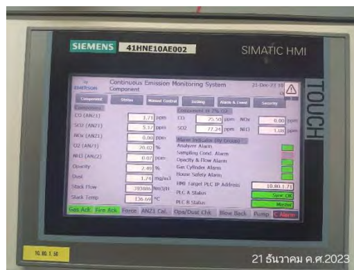
ภาพที่ 2.2-3 หน้าจอร์บบการเตือน (Alarm) เพื่อควบคุมการระบายก๊าซออกไซด์ของไนโตรเจน ( \text{NO}_x )
