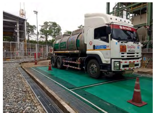
ภาพที่ 2.2-34 การวางกรวยกันรอบพื้นที่ขณะทำการขนถ่ายแอมโมเนียไฮดรอกไซด์เหลว
