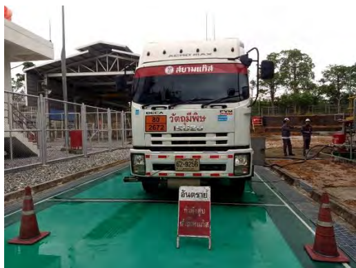
ภาพที่ 2.2-34 การวางกรวยกันรอบพื้นที่ขณะทำการขนถ่ายแอมโมเนียไฮดรอกไซด์เหลว
